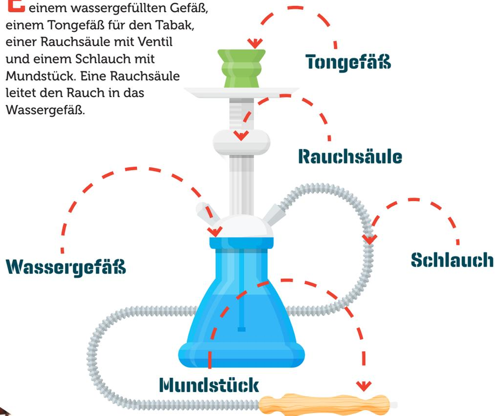
Mit einem Schlauch aus Leder oder Kunststoff wird der Rauch durch den Wasserbehälter gesogen und gelangt so gekühlt in den Mund.
